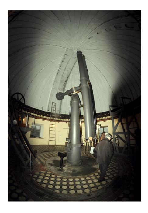
Телескоп двойной — один объектив с окуляром, просто для наблюдений, и другой с возможностью установить негатив, чтобы сделать снимок. Фотографический объектив: фокусное расстояние 6400 мм; Визуальный объектив: фокусное расстояние 6600 мм.
