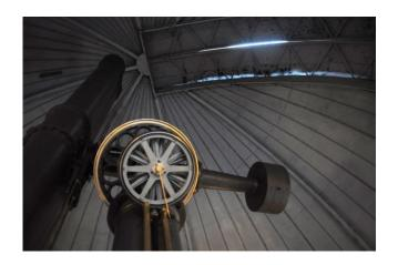
Телескоп вращается на 360 градусов вручную, а купол с электроприводом.
